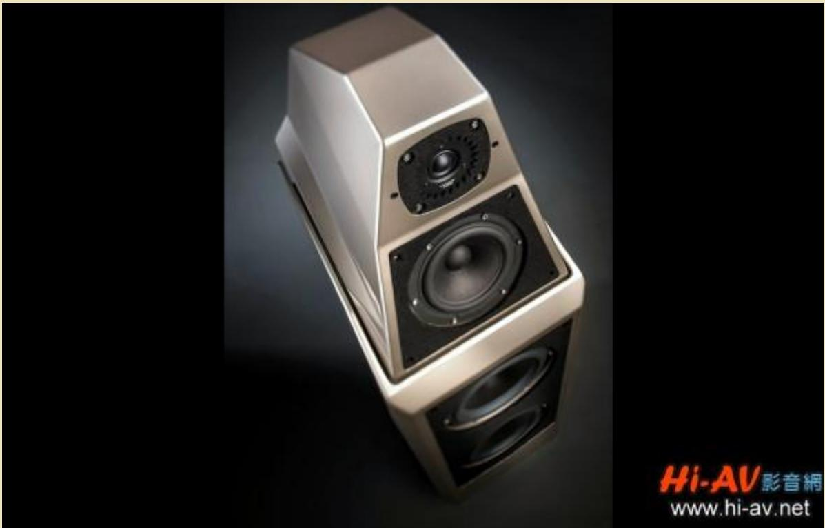
Sasha 2 裝載兩支 8 吋低音單體、一支 7 吋紙漿纖維複合振膜中音單體，以及一支延續自旗艦 XLF 創新概念的 1 吋 CST（Convergent Synergy Tweeter）絲質軟半球高音單體，整體的頻率響應規格為 20Hz-27kHz±3dB，比起前代 Sasha 的音樂重播表現更為全面。
