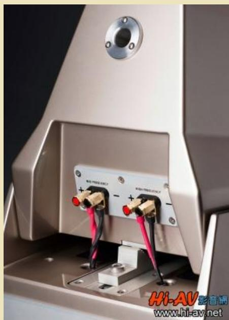
Wilson Audio 是最早提出全頻段時間相位一致性的喇叭品牌之一，因此其模組架構落地式喇叭很重要的特色，就是中、高音音箱的前後位置與角度，可根據不同聆聽狀態做調整。圖右是 Sasha 2 上模組音箱的調整裝置，相較圖左前代 Sasha 僅有中央一支不銹鋼支柱，Sasha 2 延續上級機種 Alexia 的獨特設計，以實心鋁塊前端切削為鋸齒狀「階梯」形成多個不同的刻度，搭配鋁塊的前後位置移動，就能讓中高音音箱呈現不同的發聲角度，用家當然可以進行細微精準的調整，以達到精確的時間相位一致性。
