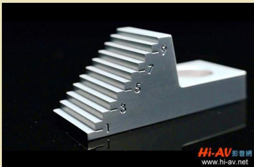
這就是 Sasha 2 調整「上模組」傾斜角度的實心鋁塊，前端共有十個「階梯」可讓上模組底部的尖錐抵住，搭配鋁塊前後的位置移動，就可讓中高音及低音的相位調整一致。
