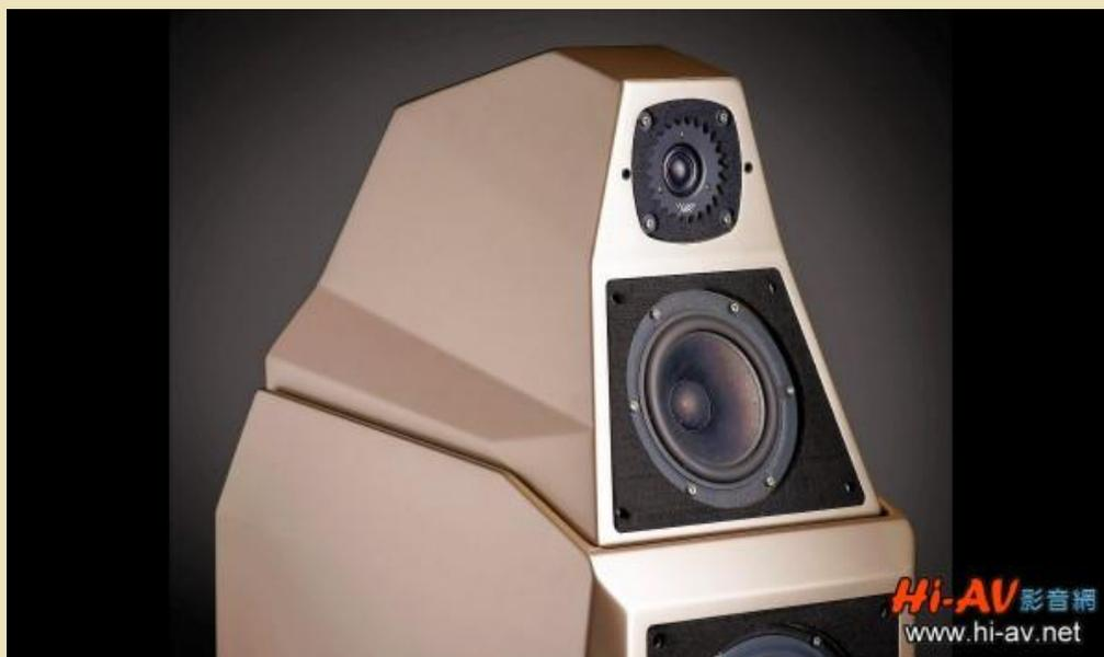
怎麼說呢？因為過去每一代的 WATT/Puppy 都是將中、高音單體裝設於同一平面上，Sasha 2 則是首度將兩者分置於兩個不同角度的平面上。如此大幅改變之目的，是為了讓高音與中音的投射夾角有所差異，使不同頻段的聲波匯聚在聆聽者的耳際（請點擊[這裡](#)察看 Wilson Audio 對於旗艦 Alexandria 系列 Aspherical Propagation Delay 「非球面傳播延遲」技術的說明圖片）。
