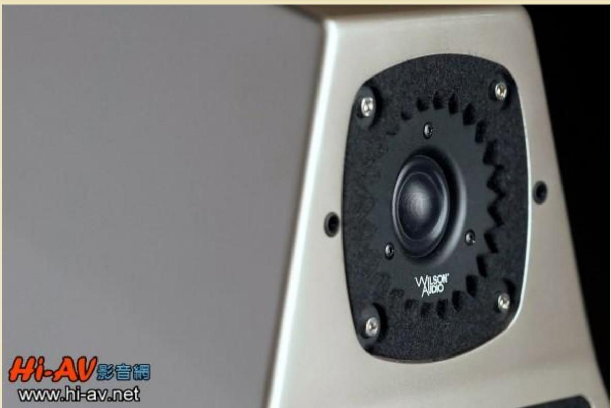
自從 Wilson Audio 首度破天荒將絲質軟半球高音單體裝載於旗艦 XLF、得到聲音性能全面提升的驚人效果（本站詳盡剖析請見[這裡](#)）後，原廠即陸續為旗下各系列喇叭進行改款。Sasha 2 捨棄前代有科技感的鈦合金凹盆高音，改用質量輕、擴散性更優異的 1 吋 CST 絲質軟半球高音，降低金屬振膜鈴振與音染的問題，頻率響應更為平坦，而且不但 極高頻延伸一舉突破 37kHz，能更完美對應新世代高解析音樂訊源，下段延伸
