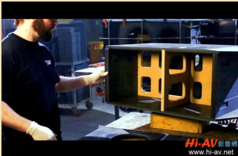
Sasha 2 音箱內部結構也不簡單，Wilson Audio 依照全新開發的獨立分析軟體設計，以超級堅硬又具備極佳阻尼特性優點的「X 材質」，構成厚度及剛性都大為提升的交叉支架，來補強音箱內部結構，提供更穩固的支撐與精準的發聲基礎。
